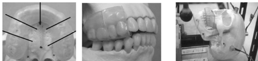
図10 マウスガード未装着に対して両マウスガードの装着時は衝撃歯のひずみを軽減 また、前歯部咬合のあるマウスガード（グラフ中で最も右）はより高い効果を示す
